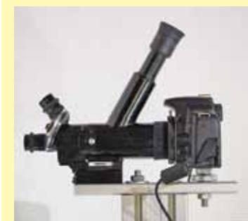
برای عکاسی میکروگرافی به میکروسکوپ یک دوربین نصب شده است.
